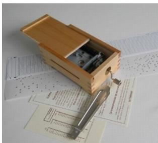
Une boîte à musique est un instrument de musique mécanique dont l'organe musical est constitué d'un ensemble de lames d'acier dont une extrémité est maintenue fermement, et dont l'autre, restée libre, est mise en vibration mécaniquement.
